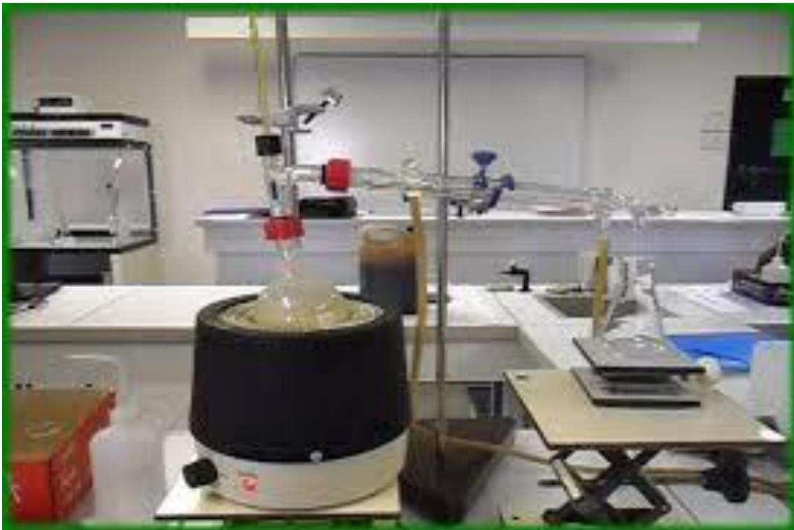
**Fig. 19 :** Équipement nécessaire pour distiller une huile essentielle.
