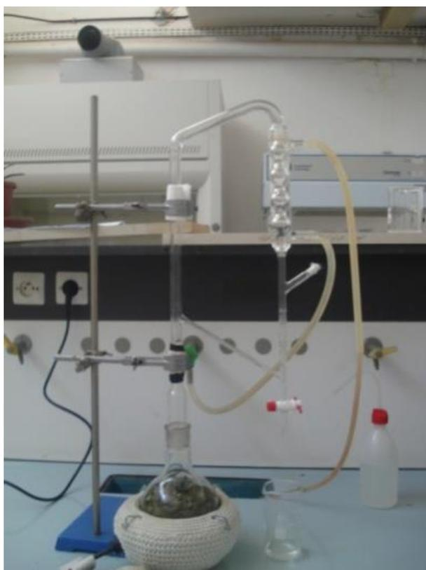
**Fig. 23** : Photographie de la hydro-distillation d'HE par le Clevenger
