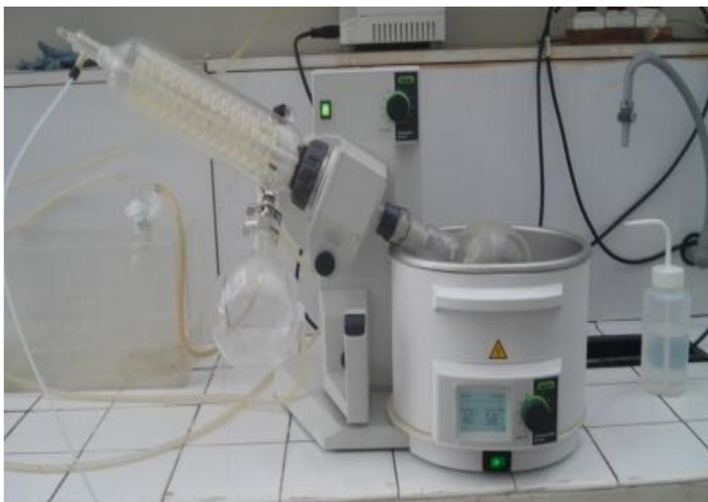
**Fig. 22** : Evaporateur rotatif
